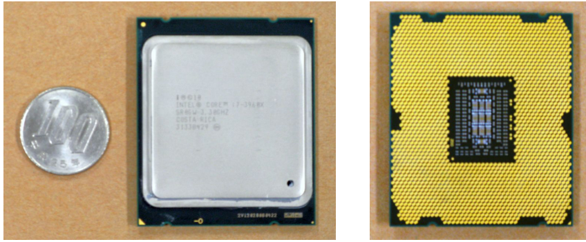
図1: Intel Core i7 3960X (6つのコアが内蔵されている)
